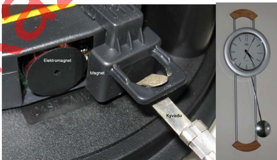
Obr. 3 Detail zavěšení kyvadla
